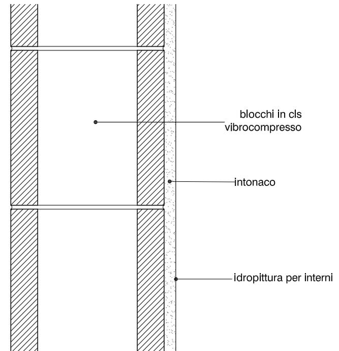
Dettaglio costruttivo di una parete in muratura portante costituita da blocchi in calcestruzzo di spessore 20 cm su cui viene applicato un intonaco civile ed eventualmente della idropittura per interni.
