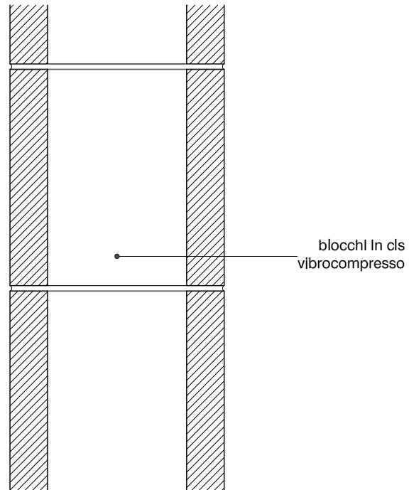
Dettaglio costruttivo di una parete in muratura portante costituita da blocchi di calcestruzzo vibrocompresso di spessore 20 cm.
