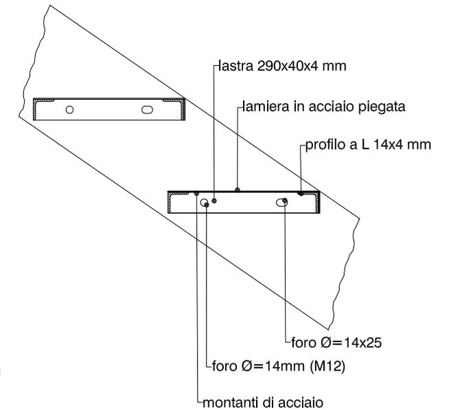
La scala di collegamento al mezzanino è concepita strutturalmente come una trave a sbalzo: due lastre in acciaio sono irrigidite da profili a L su cui viene appoggiata la lamiera del singolo scalino.
