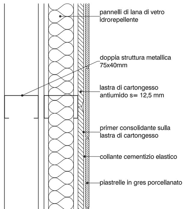
Dettaglio costruttivo di una partizione interna in cartongesso di 18,5 cm di spessore composta da una lastra in cartongesso e sostenuta da una doppia struttura metallica a C. All'interno vengono posti pannelli in lana di vetro idrorepellente. La finitura è data da piastrelle in gres porcellanato.
