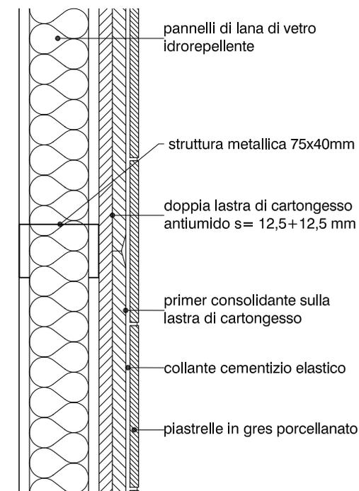
Dettaglio costruttivo di una partizione interna in cartongesso di 10 cm di spessore composta da una lastra in cartongesso e sostenuta da una struttura metallica a C. All'interno vengono posti pannelli in lana di vetro idrorepellente. La finitura è data da piastrelle in gres porcellanato.
