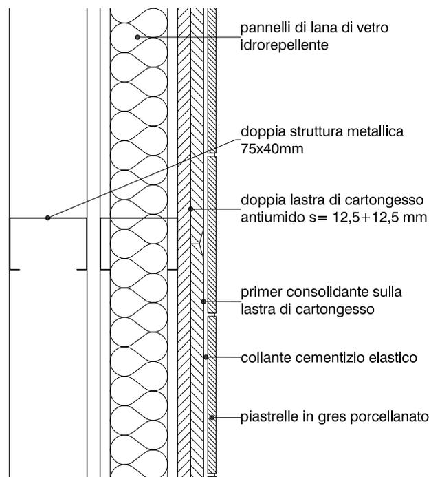
Dettaglio costruttivo di una partizione interna in cartongesso di 20 cm di spessore composta da una doppia lastra in cartongesso e sostenuta da una doppia struttura metallica a C. All'interno vengono posti pannelli in lana di vetro idrorepellente. La finitura è data dall'applicazione di piastrelle in gres porcellanato.
