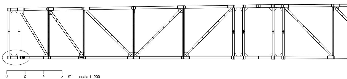
Il dettaglio costruttivo mostra la connessione dei tiranti della catena inferiore sulla testa della trave reticolare.
