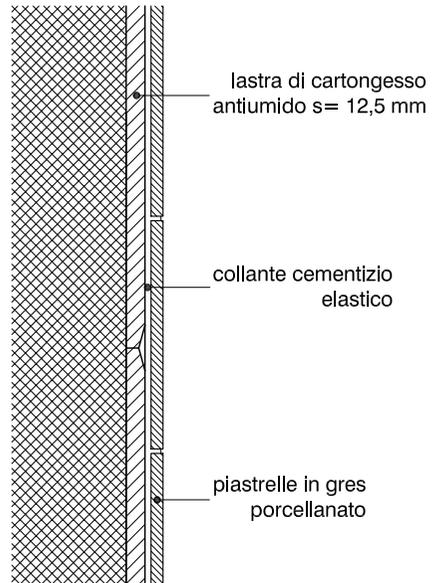
Dettaglio costruttivo di una parete in cemento rivestita con piastrelle in gres porcellanato dello spessore di 8 mm, agganciate tramite un collante cementizio elastico ad una lastra di cartongesso antiumido.
