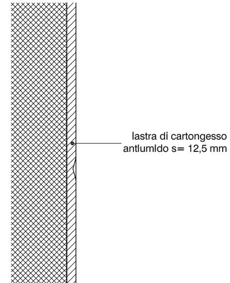
Dettaglio costruttivo di una parete in cemento rivestita con una lastra di cartongesso antiumido di 1,25 cm agganciata alla parete tramite l'uso di collanti.
