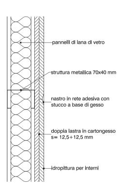
Dettaglio costruttivo di una partizione interna in cartongesso di 18 cm di spessore composta da una doppia lastra in cartongesso e sostenuta da una doppia struttura metallica a C.
