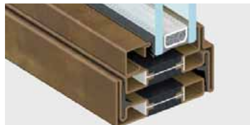
nodo inferiore | sezione in vista 47 mm
