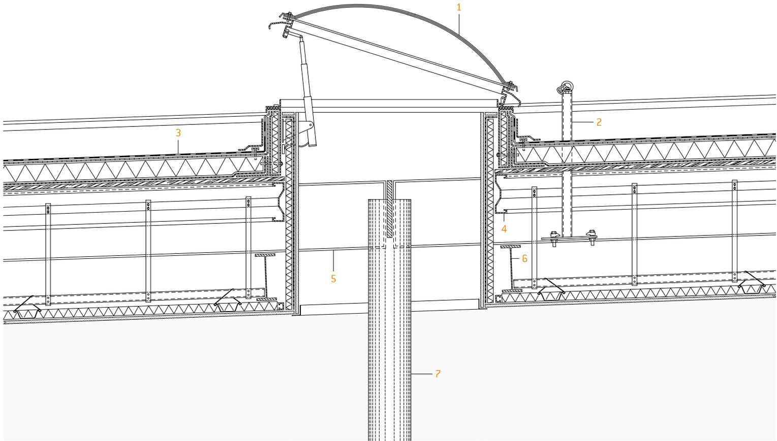
**1.** calotta di polycarbonato a triplo strato extrachiaro con dispositivo automatico per la regolazione dell'apertura, Ø 1000 mm
